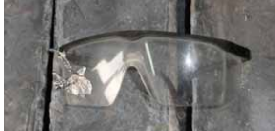
4.10 Üzerine Kurşun Sıçramış Koruyucu Gözlük
