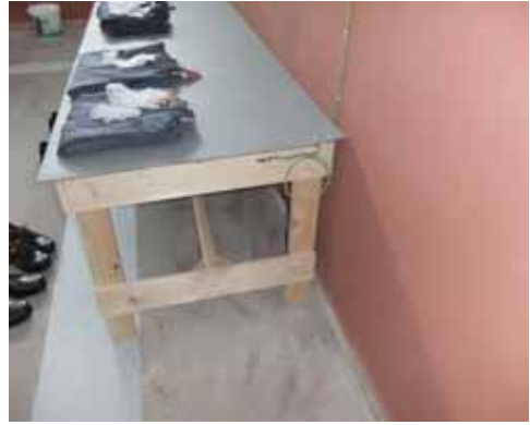
4.20 Statik Yük Topraklaması Yapılmış Çalışma Tezgahı
