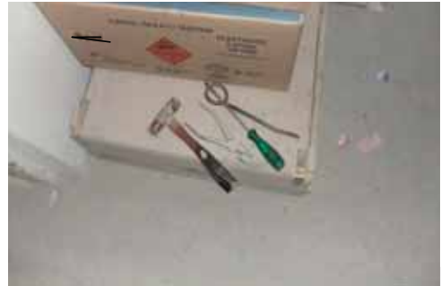
4.14 Patlayıcı Madde Ambalajı Açmakta Kullanılan Alev Çıkarabilir Aletler
