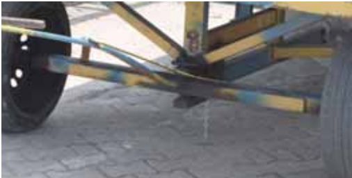
4.17 Statik Yüke Karşı Topraklanmış Patlayıcı Madde Taşıma Aracı
