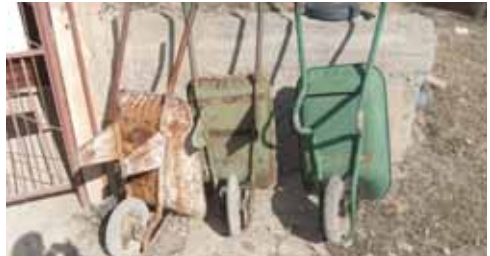
4.18 Uygun Olmayan Patlayıcı Madde Taşıma Araçları
