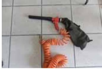
4.55 Vakumlu Toz Toplama Cihazı
