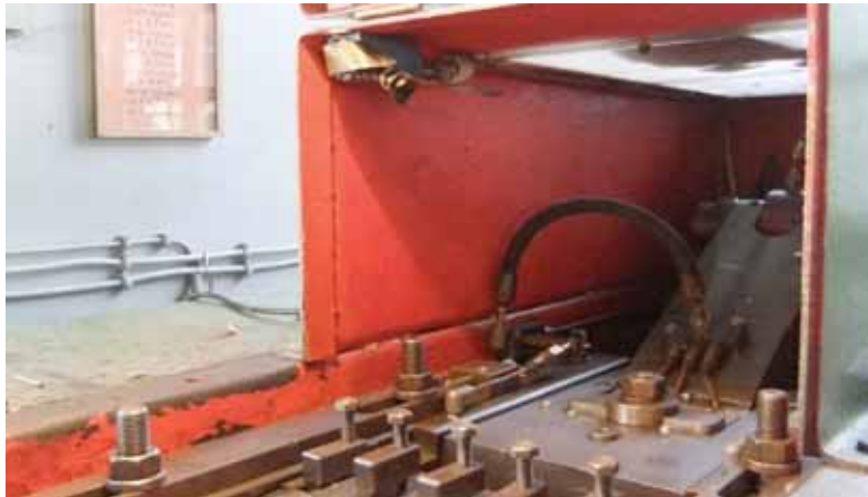
4.6 Makine Emniyet Sivcinin İş Göremez Hale Getirilmesi
