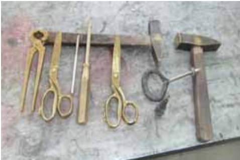
4.13 Patlayıcı Madde Ambalajı Açmakta Kullanılan Pirinç Aletler
